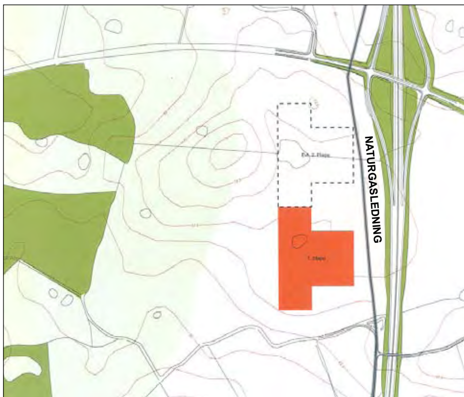
Naturgasledning langs motorvejen. Det er en forudsætning for byggeriets placering tæt på gasledningen, at den bringes op i en højere sikkerhedsklasse.
